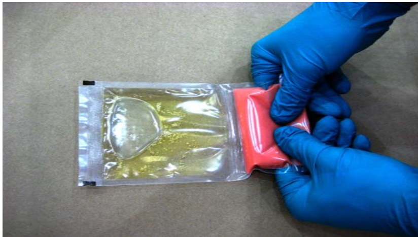
1. Roll pouch to force liquid toward burst seal. Enrollar el paquete hacia el sello para que se rompa el sello.
